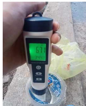
Gambar IV.4.5 Proses Kalibrasi TDS Menggunakan Aquadest
