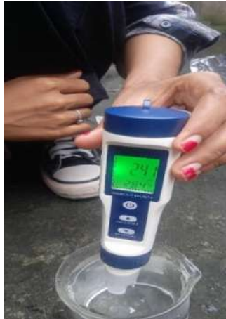
Gambar IV.4.6 Proses Pengujian Sampel Air Pada TDS Meter
