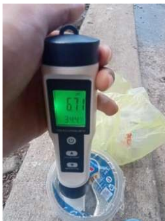
Gambar IV.4.7 Proses Kalibrasi SALINITY Menggunakan Aquadest
