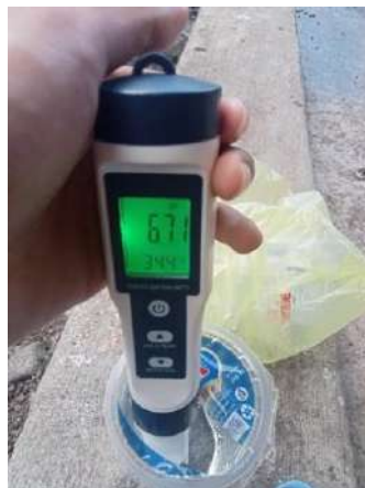
Gambar IV.4.2 Proses Kalibrasi pH Meter Menggunakan Aquadest
