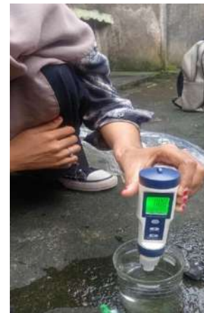
Gambar IV.4.8 Proses Pengujian Sampel Air Pada SALINITY Meter
