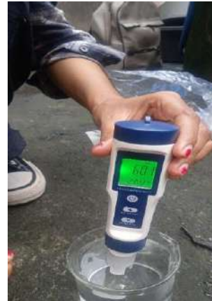
Gambar IV.4.4 Proses pengujian pH Meter
