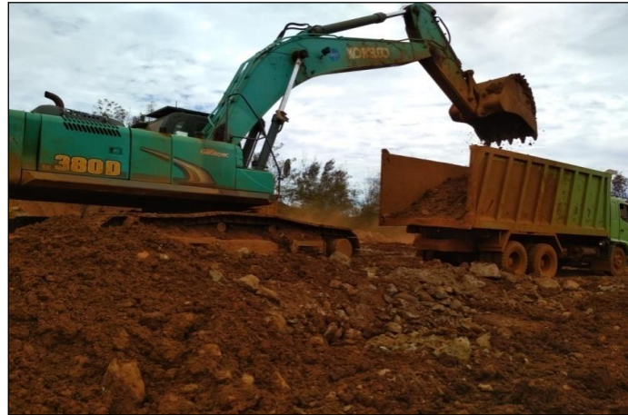
Gambar 11. Kerja Alat Muat Kobelco 380
