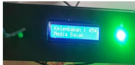
Tampilan LCD Tanah Basah Pada penelitian ini penulis melakukan pengujian alat penyiram tanaman otomatis dengan semua kondisi yaitu kondisi tanah kering, tanah cukup basah dan basah. Proses pengujian dilakukan sebanyak 10 kali dengan hasil yang berbeda beda. Untuk hasil dari penelitian dapat dilihat pada table Hasil Pengujian
