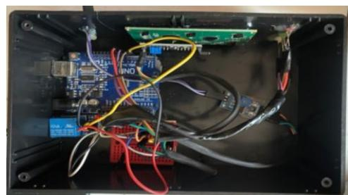
Bentuk fisik dari alat dapat dilihat pada Gambar diatas. Adapun keterangan pada gambar diatas sebagai berikut :Kabel jumper dihubungkan ke board arduino dan berfungsi sebagai penghubung semua komponen yang digunakan 1N4007 diode berfungsi untuk mengubah tegangan AC menjadi DC Relay berfungsi sebagai saklar
