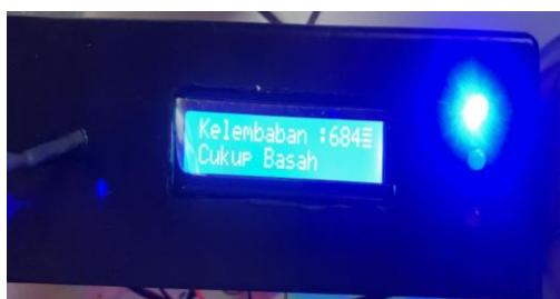
Tampilan LCD Tanah Cukup Basah Kemudian apabila sensor Soil Moisture yl-69 mendeteksi tanah dalam kondisi cukup basah maka lampu LED Biru menyala dan LCD akan menampilkan nilai lebih dari 500 maka pompa akan mati/off. Dan apabila Soil Moisture yl-69 mendeteksi tanah dalam kondisi basah maka lampu LED Hijau akan menyala dan LCD akan menampilkan nilai yang kurang dari 500
