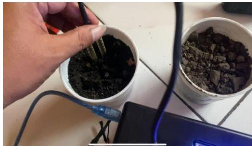
Setelah memastikan bahwa perangkat dapat berfungsi dengan baik selanjutnya uji coba perangkat penyiram tanaman otomatis
