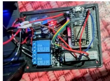
Pada gambar di atas merupakan semua tampilan dari semua rangkaian alat sistem monitoring suhu dan kelembapan yang telah berhasil dirancang.
